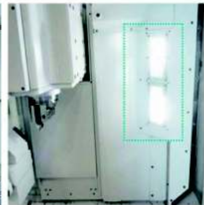
Двойная лампа под углом – упрощает проверку режущей кромки инструмента и пр.
