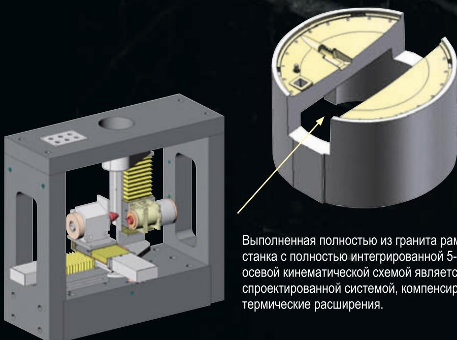
Выполненная полностью из гранита рама станка с полностью интегрированной 5-ти осевой кинематической схемой является спроектированной системой, компенсирующей термические расширения.
