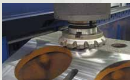
Вертикально-фрезерный станок Ingersoll – 10 м между колоннами
