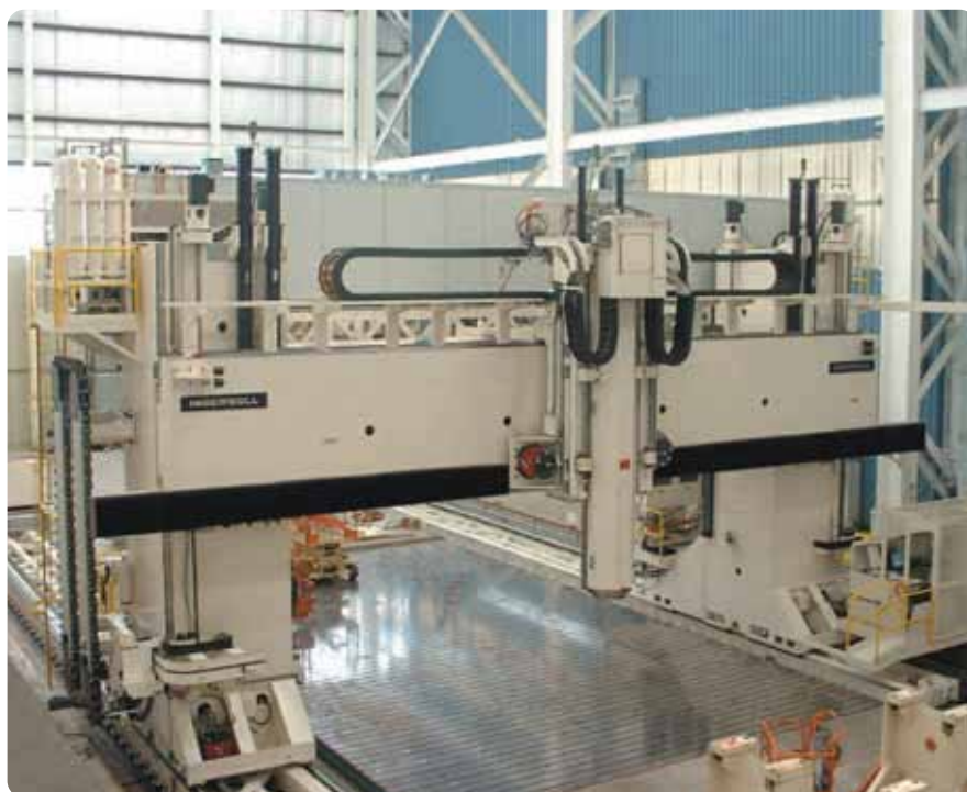
Вертикально-фрезерный станок Ingersoll – 10 м между колоннами
